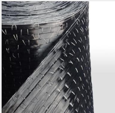
*Tessuti di armatura in fibra di carbonio ad alto modulo per rinforzi CFRP*
