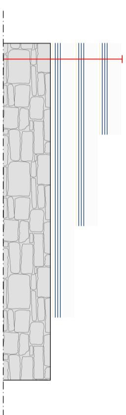
Bagnare a saturazione la superficie interessata dal rinforzamento. In alternativa, se non fosse possibile effettuare la bagnatura, applicare il primer a base di resina sintetica bicomponente in dispersione acquosa **KIMICOVER FIX**.
